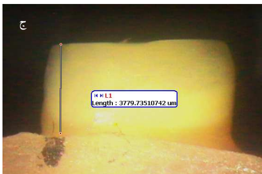
شکل ۱: ارتفاع دندان‌ها قبل (الف) و بعد از ۱۰۰۰ (ب) و ۲۰۰۰ (ج) دور سایش در زیر میکروسکوپ نوری (بر حسب میکرومتر).
