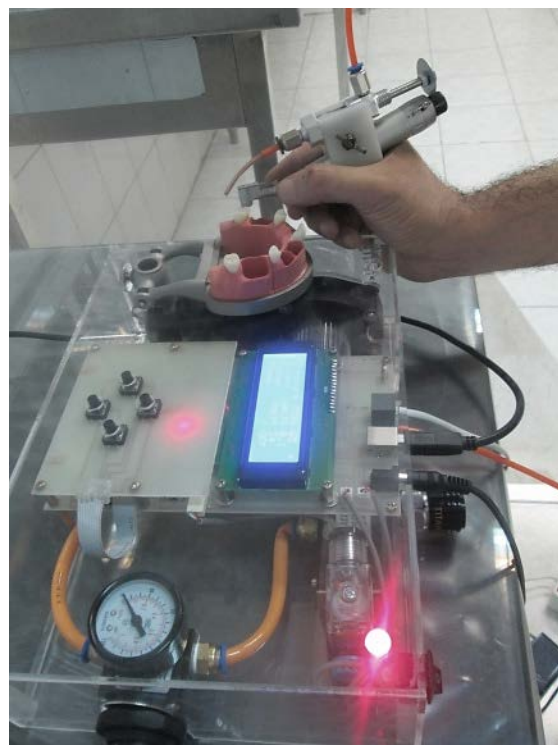
شکل ۱. نمای دستگاه جدید اتوماتیک تزریق خمیر برای پرداخت
