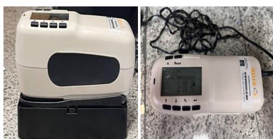
شکل ۳: تصاویری از دستگاه اسپکتروفوتومتر انعکاسی جامدات X-rite sp62
