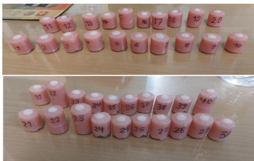
شکل ۲: نمونه‌های نهایی در قالب‌های استوانه‌ای پلاستیکی
