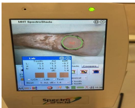
شکل ۲: بررسی رنگ دندان و ثبت L, a, b, dE در قسمت سرویکال نمونه‌ها توسط دستگاه اسپکتروفوتوشید
